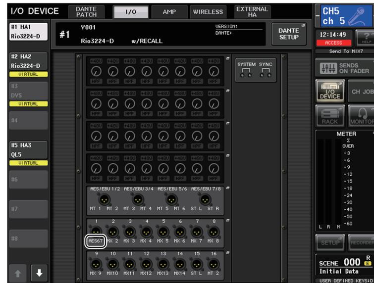
Quando la console CL/QL è in modalità AES67, le impostazioni per i parametri di seguito non possono essere modificate sulla console.
