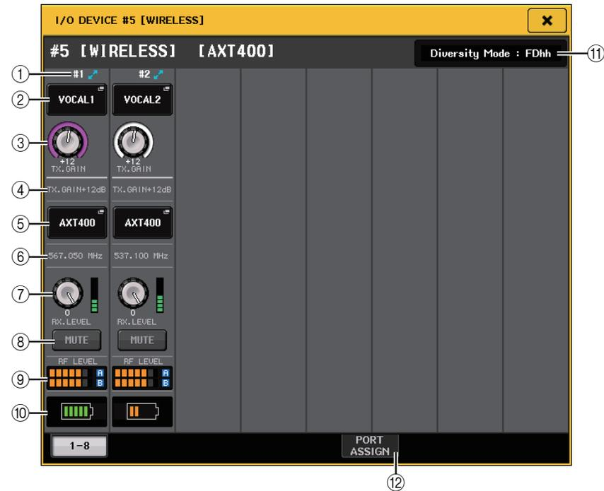
① Questo indicatore
