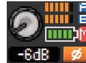
Il livello RF viene visualizzato per due canali (A e B).
