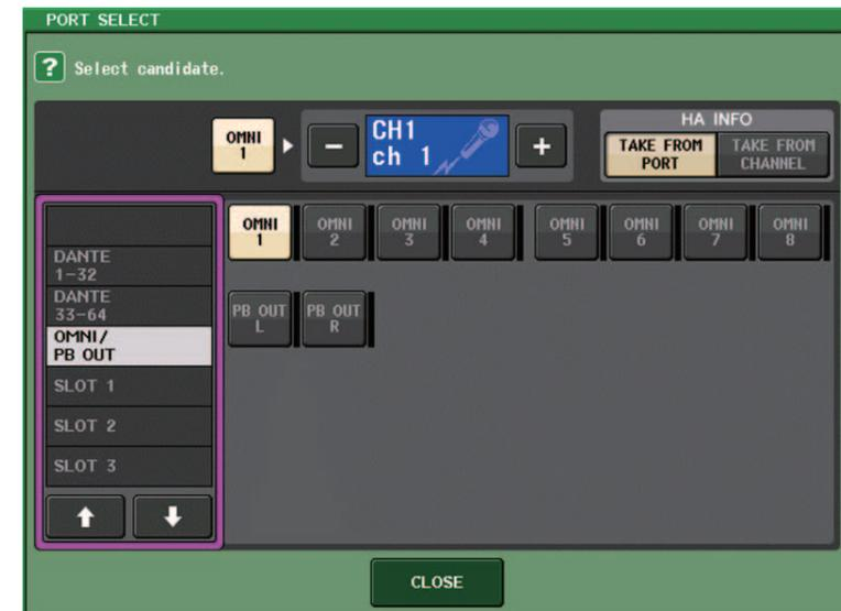
In questo modo viene assegnato il segnale di uscita da AXT400 al canale di ingresso, ed è inoltre possibile controllare e monitorare il livello di AXT400 dal canale di ingresso.
