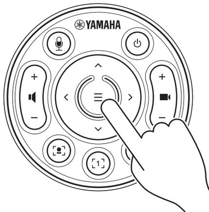
L'accoppiamento è terminato quando l'indicatore di stato sul pannello anteriore del dispositivo s'illumina in blu per 3 secondi.
