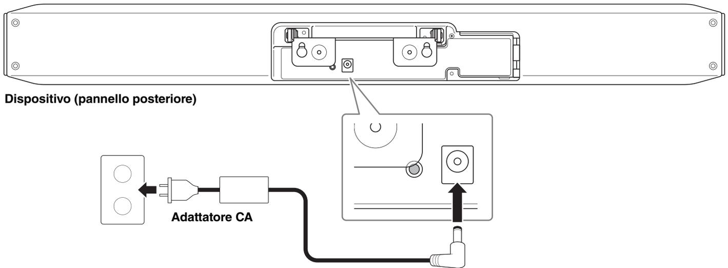
Collegando l'adattatore CA, si accende automaticamente il dispositivo.
