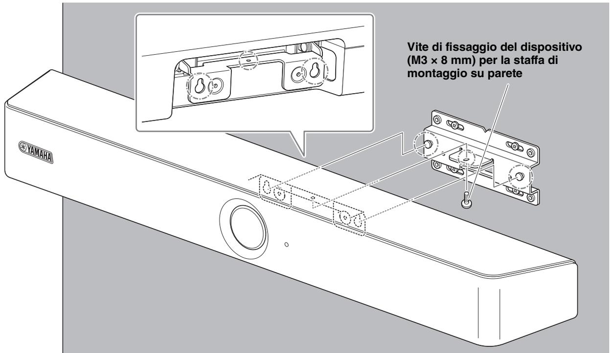
**3. Fissare il lato inferiore della staffa sul dispositivo tramite la vite di fissaggio inclusa (M3 x 8 mm).**
