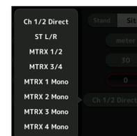
Ch 1/2 Direct preleva il segnale prima del fader, mentre ST L/R, AUX e MTRX prelevano il segnale dopo il fader.
