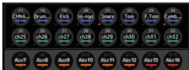
Le seguenti informazioni vengono visualizzate quando il pulsante Quick Config della console viene attivato e un'unità Tio1608-D con l'interruttore [QUICK CONFIG] attivo è collegata.
