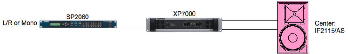
**Esempio di configurazione SP2060**
