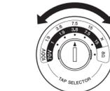
L'illustrazione mostra l'impostazione a 7,5 W per una linea a 100 V e a 3,8 W per una linea a 70 V.
