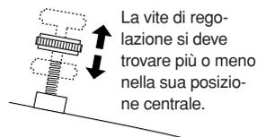
1 Prima di mettere le corde dello strumento, impostare la vite per l'intonazione fine in modo che si trovi più o meno nella sua posizione centrale. Questo vale per tutte le viti di regolazione fine.
