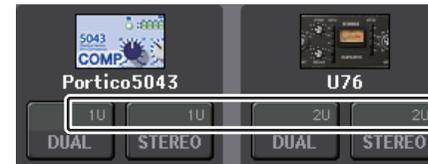
O U76 ocupa dois espaços de rack. Os outros processadores ocupam um espaço. Se você montar um processador Premium Rack no rack, não poderá montar mais nenhum outro processador abaixo desses espaços. Além disso, você não poderá montar um processador de dois espaços em um rack com numeração par.
