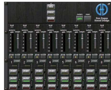
Pressione essa área para abrir a janela AUTOMIXER EDIT, na qual é possível modificar as configurações do Automixer.
