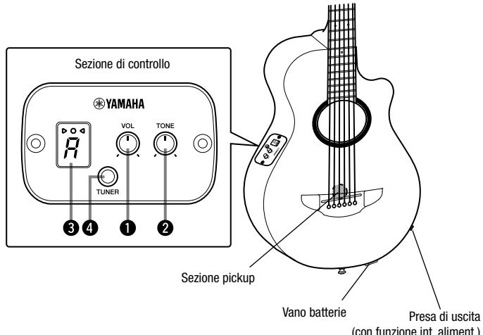
**Il preamplificatore integrato viene acceso automaticamente (ON) quando il cavo di una chitarra viene collegato alla presa di uscita.**
