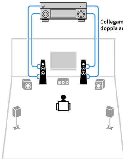
**Abbinamento con un amplificatore esterno (per Hi-Fi ecc.) per ampliare il sistema**
