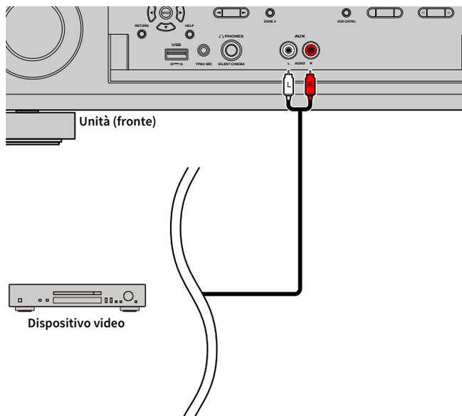
Se si seleziona “AUX” come sorgente di ingresso premendo INPUT, il segnale audio riprodotto sul dispositivo verrà trasmesso dall'unità.
