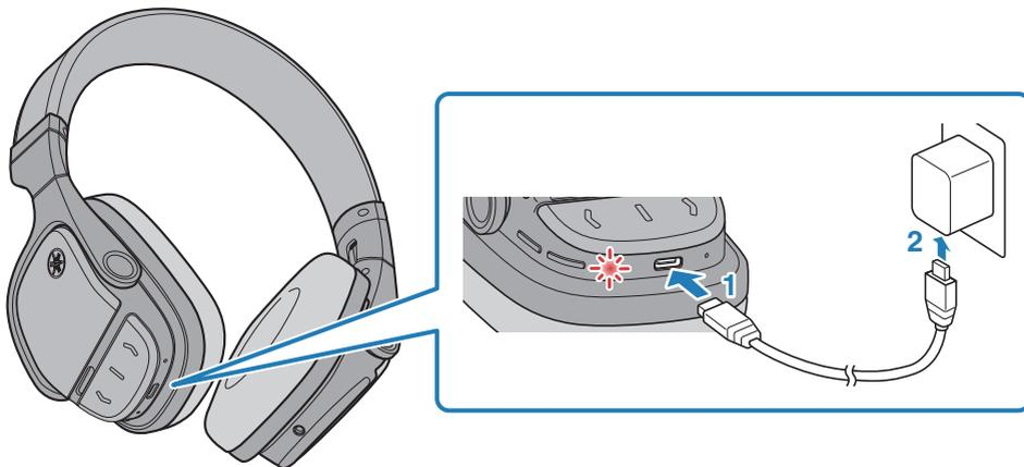
**1 Inserire il cavo di alimentazione USB nel connettore.**
