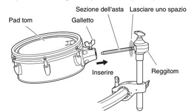
3. Allentare i galletti da A a D e i bulloni di fissaggio da C a D come illustrato di seguito per regolare l'altezza e l'angolazione dei pad. Una volta effettuato il corretto posizionamento, accertarsi di serrare di nuovo i bulloni in modo appropriato prima di procedere con l'operazione successiva.
