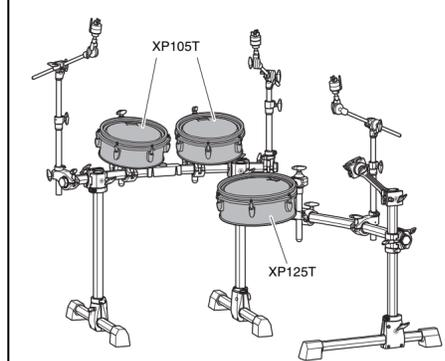
1. Assemblare i reggitori (x3) sul rack per batteria elettronica come mostrato sopra, quindi serrare il bullone di fissaggio per fissare il supporto in posizione.
