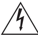
L'éclair avec une flèche à l'intérieur d'un triangle équilatéral est destiné à attirer l'attention de l'utilisateur sur la présence d'une « tension dangereuse » non isolée à l'intérieur de l'appareil, pouvant être suffisamment élevée pour constituer un risque d'électrocution.
