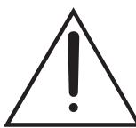
Le point d'exclamation à l'intérieur d'un triangle équilatéral est destiné à attirer l'attention de l'utilisateur sur la présence d'instructions importantes sur l'emploi ou la maintenance (réparation) de l'appareil dans la documentation fournie.
