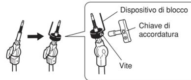
3. Fissare nuovamente sul reggipiatti il modulo di innalzamento rimosso nel passo 1 e ruotarlo in senso orario per stringerlo.
