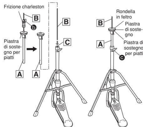
10. Montare il pad charleston RHH135. Fare riferimento alla sezione "Configurazione" nel Manuale di istruzioni dell'RHH135.
