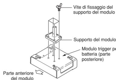
2. Montare il supporto del modulo al morsetto di sostegno, quindi stringere la manopola per fissarlo in posizione.
