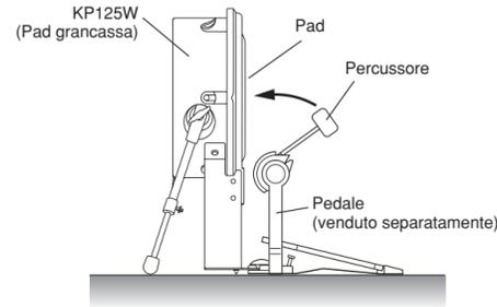
4. Posizionare il supporto charleston, il pad grancassa e il pad rullante in base alle necessità, facendo riferimento alla sezione "Assemblaggio standard dell'unità" nella prima pagina.
