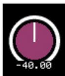
Mentre si utilizzano gli encoder multifunzione per azionare la manopola, la linea che indica l'impostazione della manopola si allunga, mentre la linea che circonda la manopola diventa più sottile; ciò consente di identificare chiaramente la manopola che si sta utilizzando. Inoltre, il valore numerico verrà racchiuso in un riquadro.
