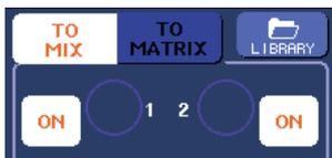
Se il bus MIX di destinazione della mandata è di tipo VARI, la manopola TO MIX SEND LEVEL viene visualizzata nello stesso colore dell'encoder corrispondente della sezione SELECTED CHANNEL. In questo caso, è possibile utilizzare l'encoder corrispondente dalla sezione SELECTED CHANNEL per regolare il livello di mandata.
