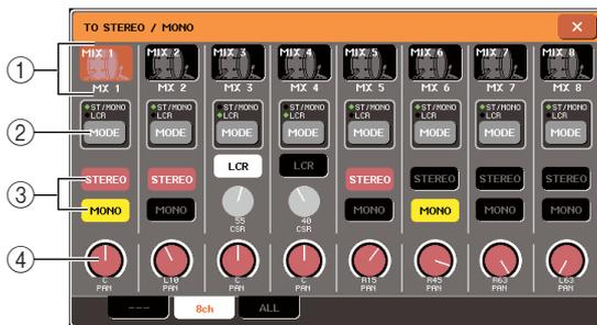
In questa finestra è possibile controllare le impostazioni di attivazione/disattivazione e di pan/bilanciamento del segnale inviato dai canali MIX ai bus STEREO (L/R) e MONO (C), in gruppi di otto canali.
