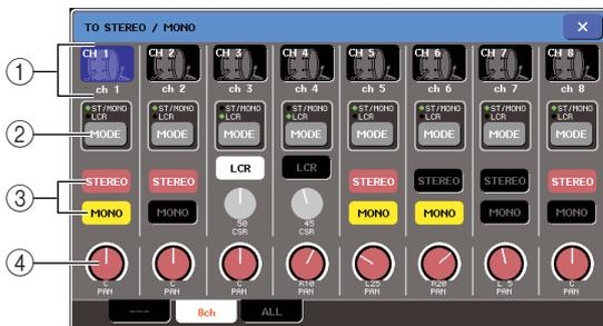
In questa finestra è possibile controllare le impostazioni di attivazione/disattivazione e di pan/bilanciamento del segnale inviato dai canali di ingresso ai bus STEREO (L/R) e MONO (C), in gruppi di otto canali.
