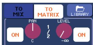
Per un canale INPUT, la manopola destra consente di regolare il livello di mandata comune ai due bus MATRIX, mentre la manopola sinistra consente di regolare il pan tra i due bus MATRIX. La rotazione verso sinistra della manopola sinistra TO MATRIX SEND LEVEL determinerà un aumento della quantità di segnale inviata al bus MATRIX con numerazione dispari, mentre la rotazione verso destra determinerà un aumento della quantità di segnale inviata al bus MATRIX con numerazione pari.
