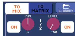
Per un canale INPUT, la manopola destra consente di regolare il livello di mandata comune ai due bus MIX, mentre la manopola sinistra consente di regolare il pan tra i due bus MIX. La rotazione verso sinistra della manopola sinistra TO MIX SEND LEVEL determinerà un aumento della quantità di segnale inviata al bus MIX con numerazione dispari, mentre la rotazione verso destra determinerà un aumento della quantità di segnale inviata al bus MIX con numerazione pari.
