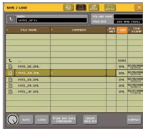
**4** Per selezionare il file di Help (estensione: .xml) da caricare, premere il file di Help desiderato nell'elenco oppure ruotare l'encoder multifunzione sul pannello.
