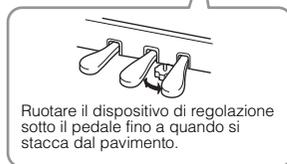
Ruotare il dispositivo di regolazione sotto il pedale fino a quando si stacca dal pavimento.
