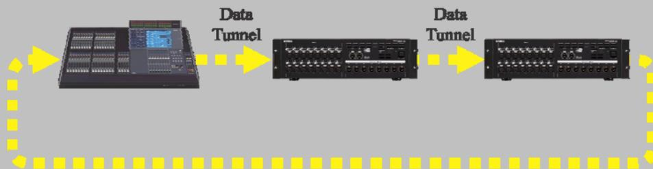
Se si controllano in remoto unità SB168-ES, i 16 head amp di SB168-ES saranno visualizzati come due unità AD8HR nel display della console.
