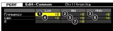
Si tratta di un equalizzatore parametrico a tre bande (Low, Mid, High). La banda alta (High) e la banda bassa (Low) sono di tipo shelving. La banda media (Middle) è di tipo peaking.
