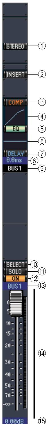
Quando è selezionato il pulsante Master LAYER nella finestra Master, vengono visualizzati i canali di Bus Out e Aux Send. Qui viene indicato un canale di Bus Out. I canali di Aux Send appaiono identici a quelli delle Bus Outs, ma solo quest'ultime dispongono di un pulsante STEREO.
