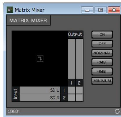
6. Configurare le impostazioni in modo che gli ingressi 1 e 2 vengano trasmessi all'uscita 1, immettere "SD" per l'uscita 1, quindi fare clic sul pulsante [x] in alto a destra per chiudere l'editor del componente.
