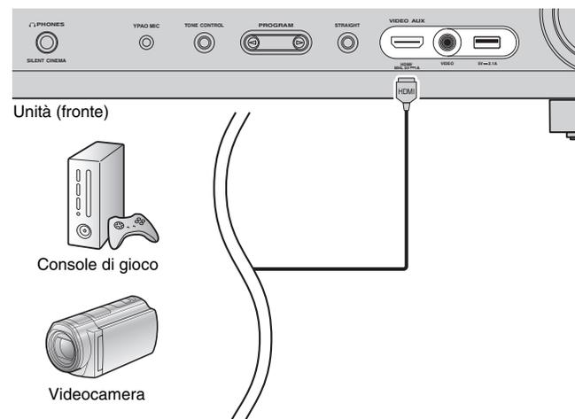
Se si seleziona "V-AUX" come sorgente di ingresso premendo V-AUX, il segnale video/audio riprodotto sul dispositivo video verrà trasmesso dall'unità.
