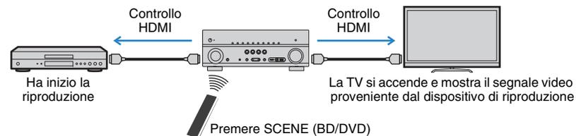
Per utilizzare la funzione di controllo HDMI, occorre configurare il collegamento Controllo HDMI dopo aver collegato la TV e i dispositivi di riproduzione.
