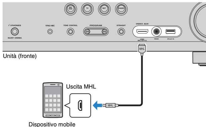
Se si seleziona "V-AUX" come sorgente di ingresso premendo V-AUX, il segnale video/audio riprodotto sul dispositivo video verrà trasmesso dall'unità.
