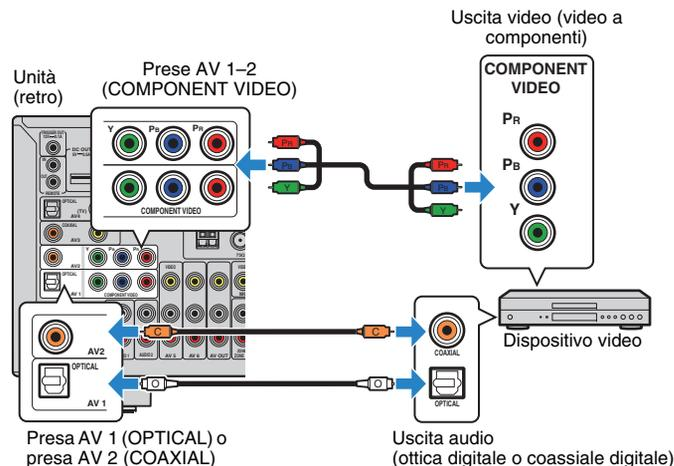
Se si seleziona la sorgente di ingresso premendo AV 1-2, il segnale video/audio riprodotto sul dispositivo video verrà trasmesso dall'unità.
