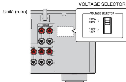
Una volta completati i collegamenti, inserire il cavo di alimentazione.
