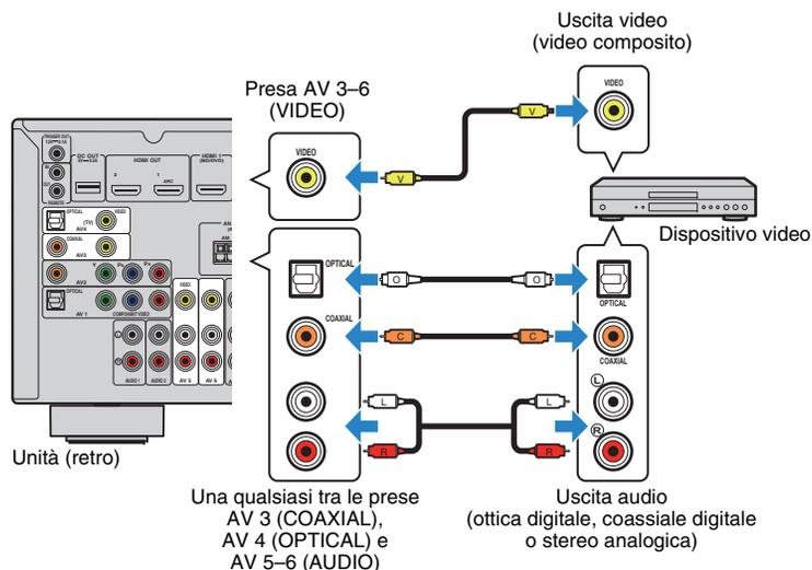
Se si seleziona la sorgente di ingresso premendo AV 3-6, il segnale video/audio riprodotto sul dispositivo video verrà trasmesso dall'unità.
