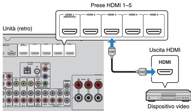
Se si seleziona la sorgente di ingresso premendo HDMI 1-5, il segnale video/audio riprodotto sul dispositivo video verrà trasmesso dall'unità.
