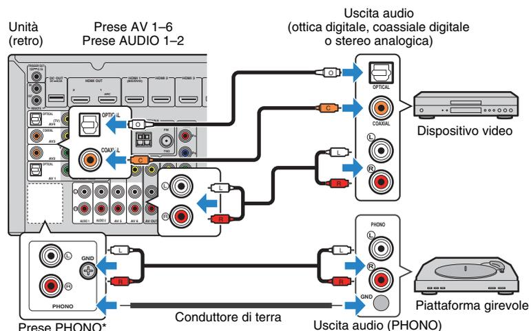
Se si seleziona la sorgente di ingresso premendo AV 1-6, AUDIO 1-2 o PHONO\*, il segnale audio riprodotto sul dispositivo audio verrà trasmesso dall'unità.
