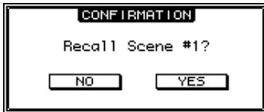
Per eseguire la funzione, spostare il cursore su YES (SI) e premere [ENTER] oppure spostare il cursore su NO e premere [ENTER] per annullare. Se per un certo tempo non si eseguono operazioni, la finestra di conferma si chiude automaticamente e la funzione non viene eseguita.
