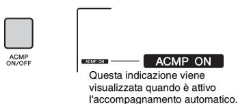
Con questa operazione, la sezione di tasti a sinistra del punto di split diventa "l'area di accompagnamento automatico" ed è utilizzata solo per eseguire gli accordi. La parte ritmica, nonché i suoni di accompagnamento con bassi e accordi, vengono riprodotti quando si suonano gli accordi.
