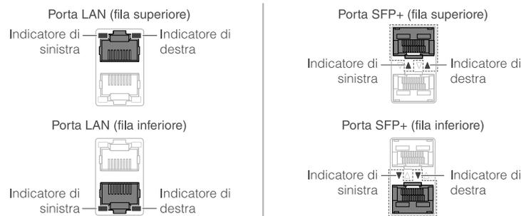
Ci sono diverse modalità di visualizzazione, inclusa la modalità "LINK/ACT" (in cui vengono visualizzati lo stato e la velocità di collegamento), la modalità "STATUS" (in cui viene visualizzato lo stato di errore) e la "modalità OFF" (in cui l'indicatore della porta è spento). Di solito, il prodotto opera in modalità LINK/ACT o in modalità OFF.
