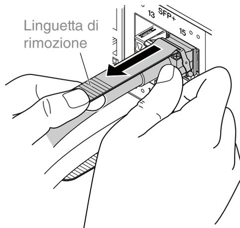
2. Quando il blocco viene rilasciato, continuare a tirare a sé la linguetta di rimozione ed estrarre lentamente la sezione del modulo SFP+.
