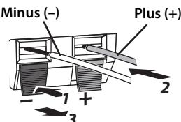
Anmärkning: Se till att kontakten griper den blottlagda ledningen, inte isoleringen.
