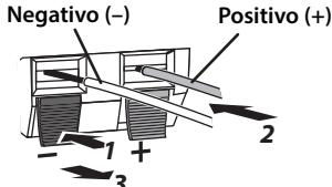
Nota: Compruebe que el terminal sujeté los cables pelados y no la parte aislada.
