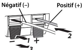
Remarque: Vérifiez que la borne serre le fil dénudé et non l'isolant.
