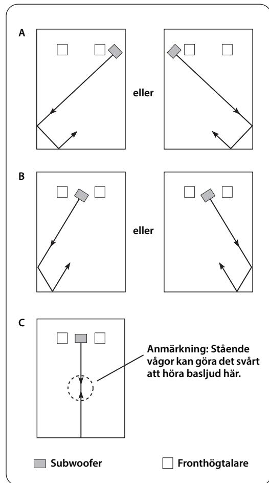
Placeringen som visas i **C** är också möjlig, men, om subwoofern är placerad direkt vänd mot en vägg och lyssningspositionen är i mitten av rummet, kan det hända att du inte får tillräckligt med basljud från subwoofern. Anledningen till detta är att "stående vågor" uppstår mellan två parallella väggar och tar ut basljuden. Placera i så fall subwoofern i en vinkel mot väggen. Det kan vara nödvändigt att stycka upp parallella väggtytor genom att sätta upp bokhyllor eller liknande på väggarna.
